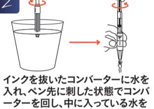
インクを抜いたコンバーターに水を入れ、ペン先に刺した状態でコンバーターを回し、中に入っている水を押し出してください。これを5~6回繰り返します。
